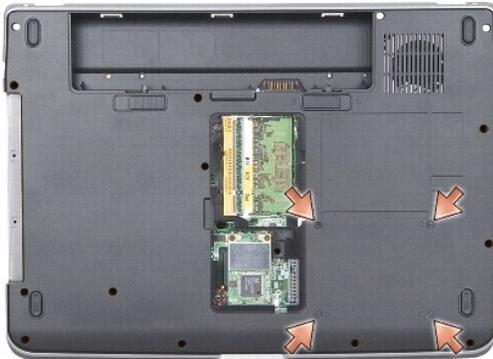
13. Entfernen Sie die zwei verbleibenden Schrauben, mit denen die Systemplatine am Computerboden befestigt ist.
